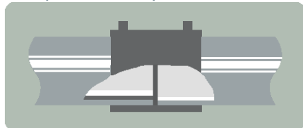
Пример сварки материала PPRCTRP, выполненной электромужовой.
